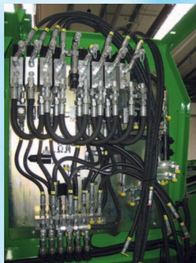
Vergleich zweier Systeme: Oben die Musterlösung, rechts die vorherige Situation. Der Einsatz des Steuerblockes vereinfacht die Montage, verringert die Zahl der Dichtstellen und verbessert die Zuverlässigkeit.
