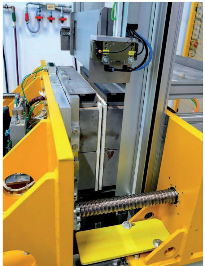
*Von oben senkrecht zugeführt wird das Teil in der Wärmezone, je nach Werkstoff und Abmessung, auf zirka 900 °C erwärmt. Zur Aufnahme und Freigabe fahren die beiden Heizplatten auseinander oder zusammen. Schön zu sehen: der Weg des Bauteils senkrecht von oben nach unten mit Platinenhalter, Wärmezone und dem darunter (von der Spindel verdeckt) liegenden Umformwerkzeug.*
